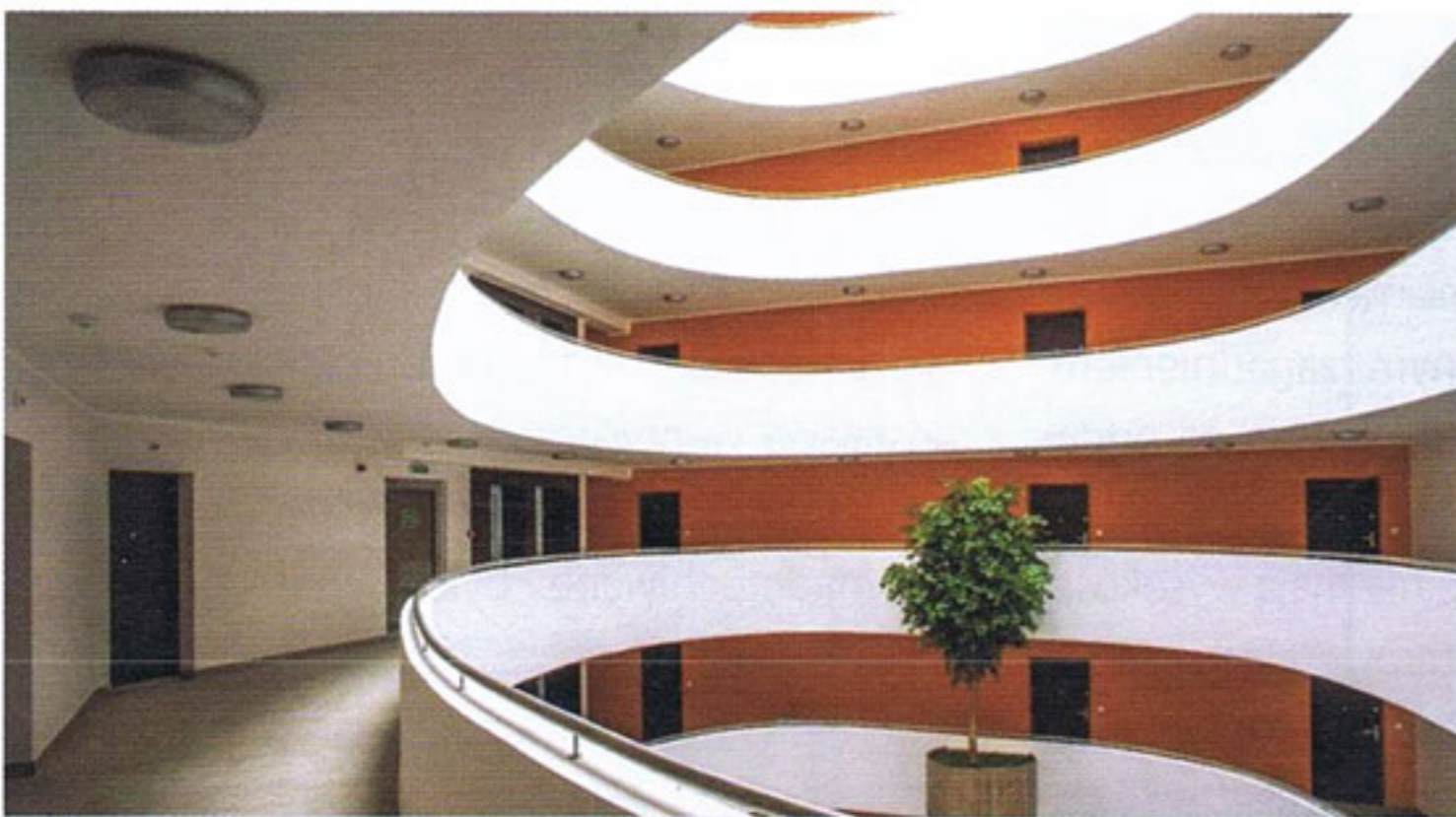
3. W przestrzeni atrium zastosowano czujniki dymu (jako dodatkowe zabezpieczenie gwarantujące szybkie wykrycie pożaru w przypadku niezadziałania czujnika dymu w mieszkaniu). Natychmiast po wykryciu pożaru następuje w atrium przełączenie systemu wentylacji bytowej w tryb oddymiania i informacja o tym jest przekazywana do odpowiedniej jednostki Państwowej Straży Pożarnej
