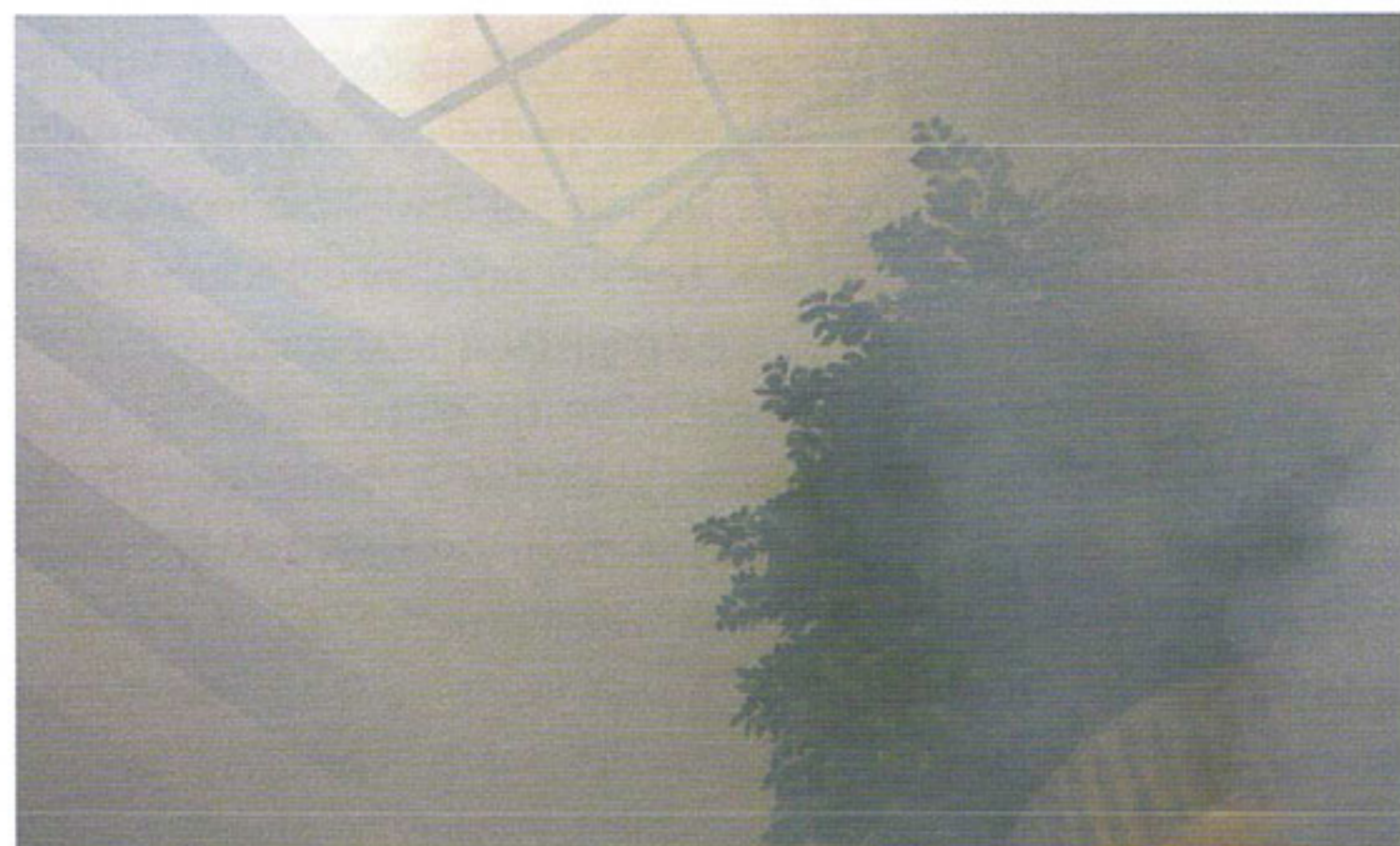
7. Atrium wypełnione dymem podczas symulacji pożaru
